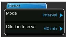
En fonction du mode de contrôle des cycles de dilution, vous devez configurer les paramètres "Fill Cycle", "Condu Limit", "H2O Temp" ou "Interval".
