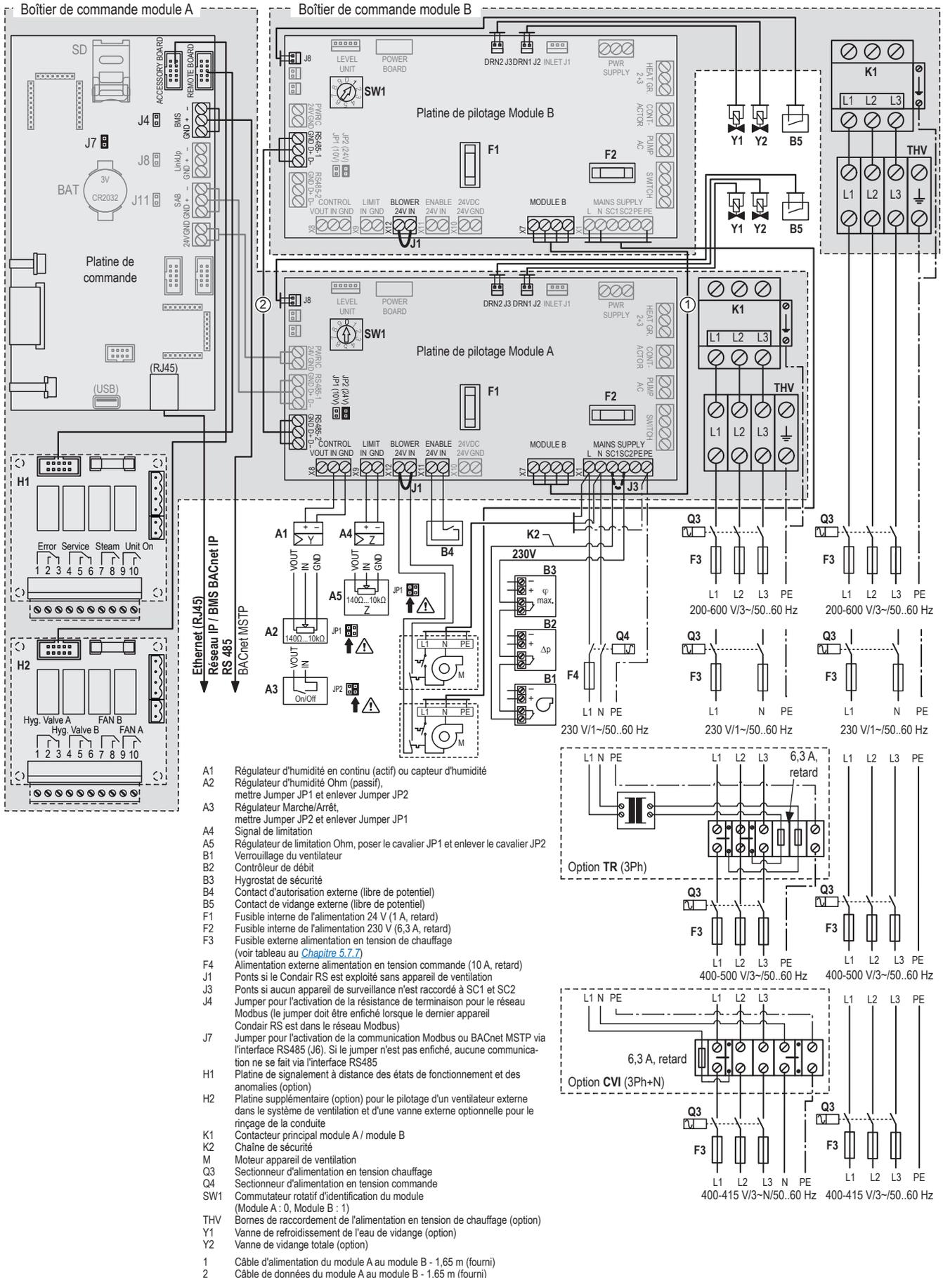
Fig. 29: Schéma électrique Condaïr RS - Appareils doubles (2 x "M") 40...80 kg/h
