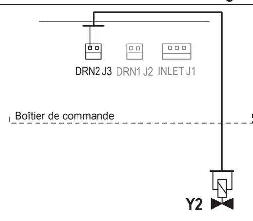
Le câble de raccordement de la vanne de vidange totale "Y2" disponible en option est raccordé à la barrette à bornes "DRN2 J3" de la platine de pilotage correspondante dans l'unité de commande conformément au schéma.
