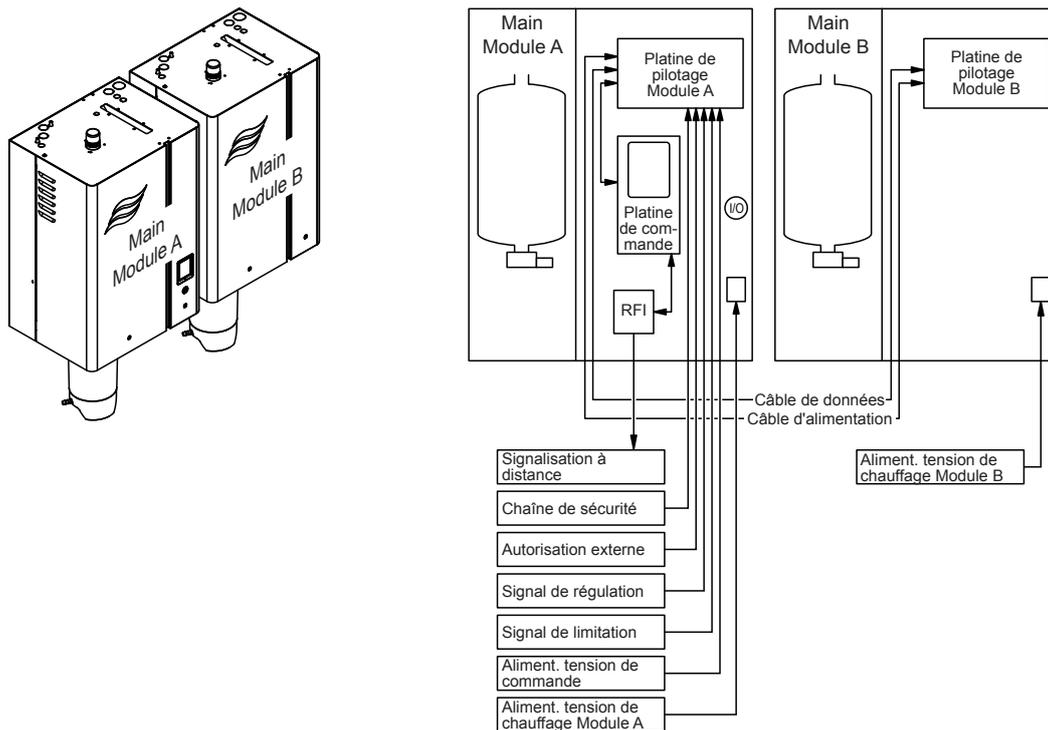
Fig. 3: Aperçu appareils doubles (2 x "M")
