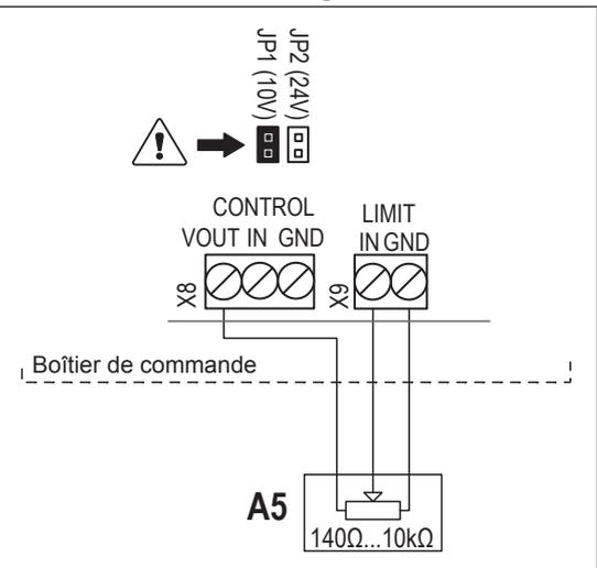
Le câble de signal d'un régulateur de limitation Ohm externe (140 Ω...10 kΩ) est connecté aux contacts "VOUT" (bornier "X8"), "IN" et "GND" (bornier "X9") sur la platine de pilotage de l'unité de commande conformément au schéma.
