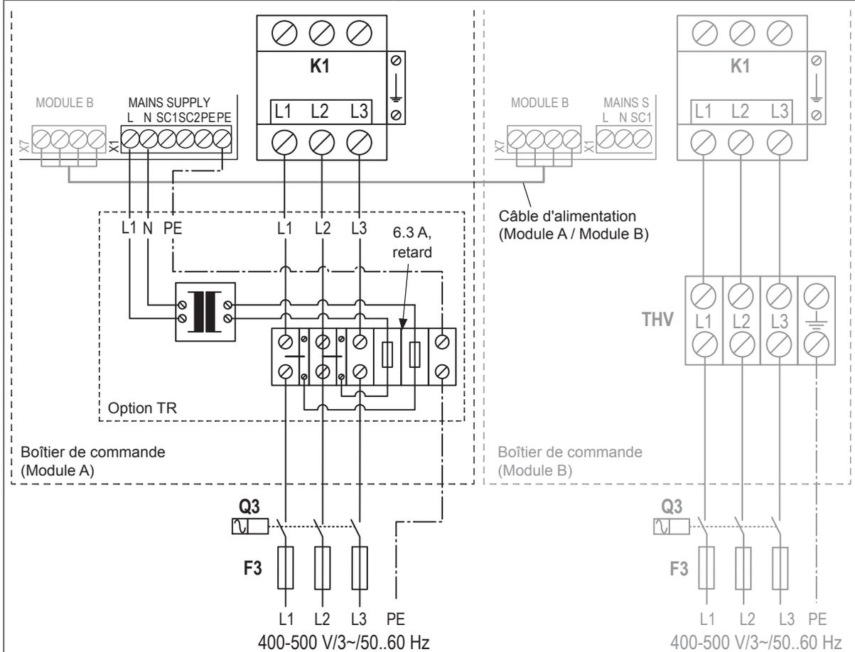
Le raccordement de l'alimentation en tension (L1, L2, L3 et PE) se fait sur les bornes correspondantes de l'option TR conformément au schéma. Le câble de raccordement doit absolument être amené dans le boîtier de commande via la fixation de serrage.
