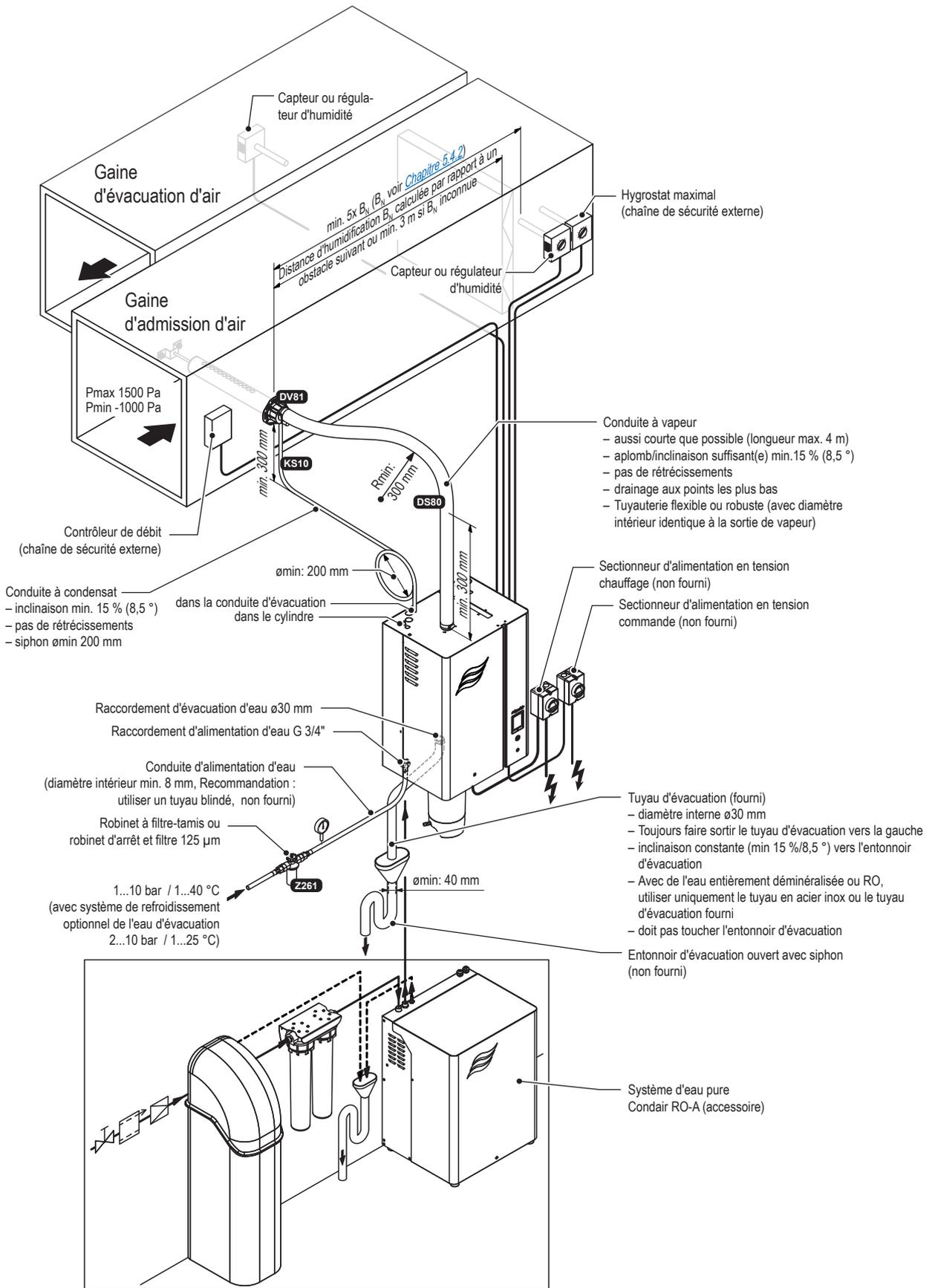
Fig. 7: Installation typique pour humidification de gaine
