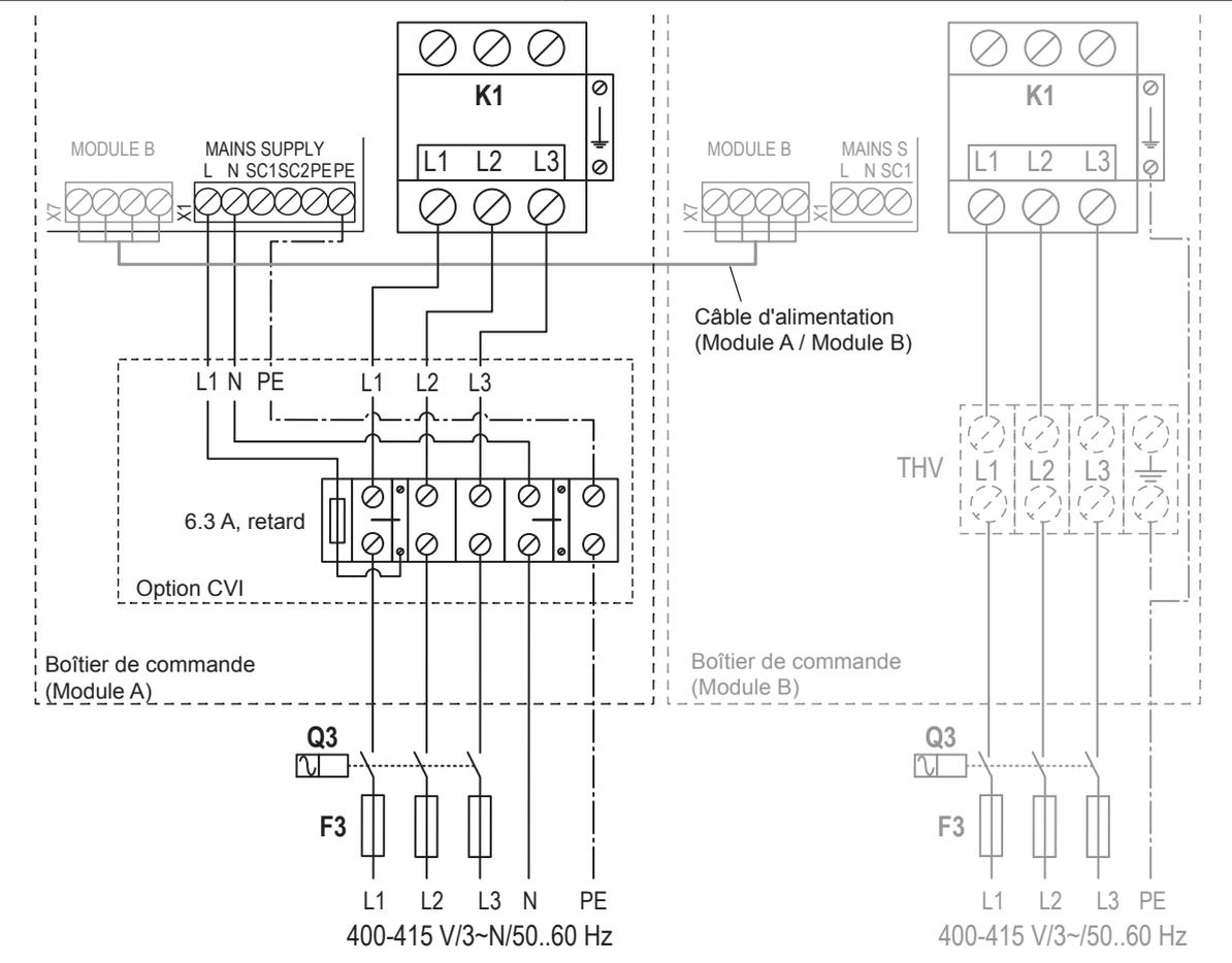
Le raccordement de l'alimentation de tension (L1, L2, L3, N et PE) se fait sur les bornes correspondantes de l'option CVI conformément au schéma. Le câble de raccordement doit absolument être amené dans le boîtier de commande via la fixation de serrage.
