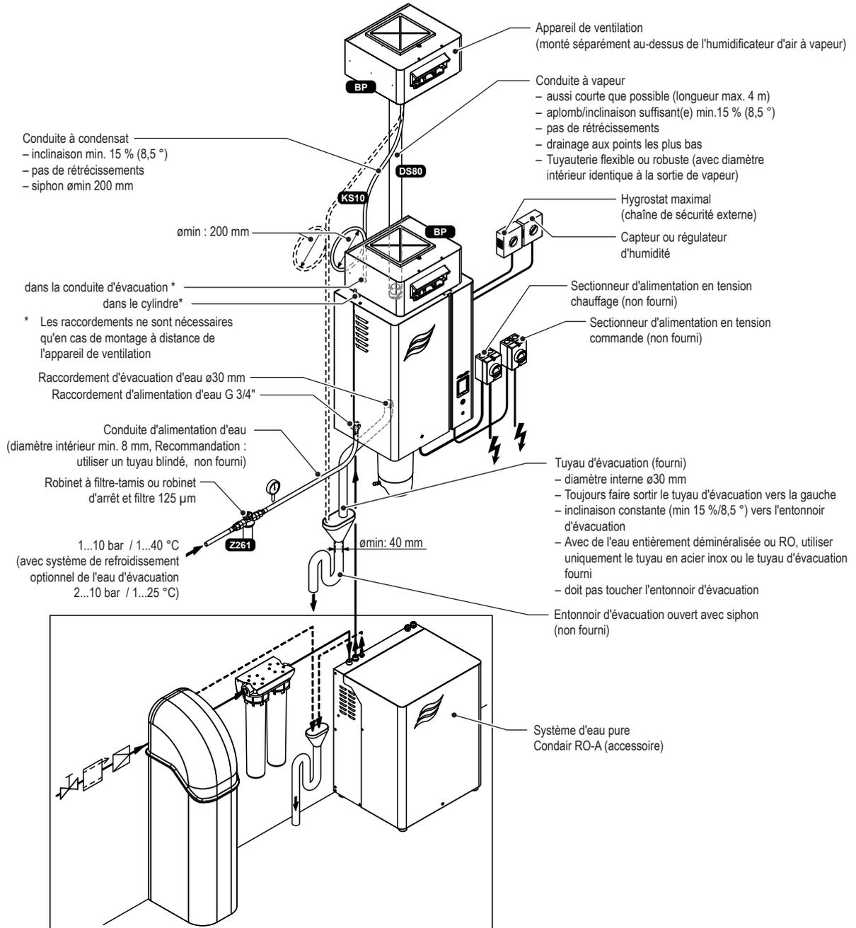
Fig. 8: Installation typique pour humidification directe de local
