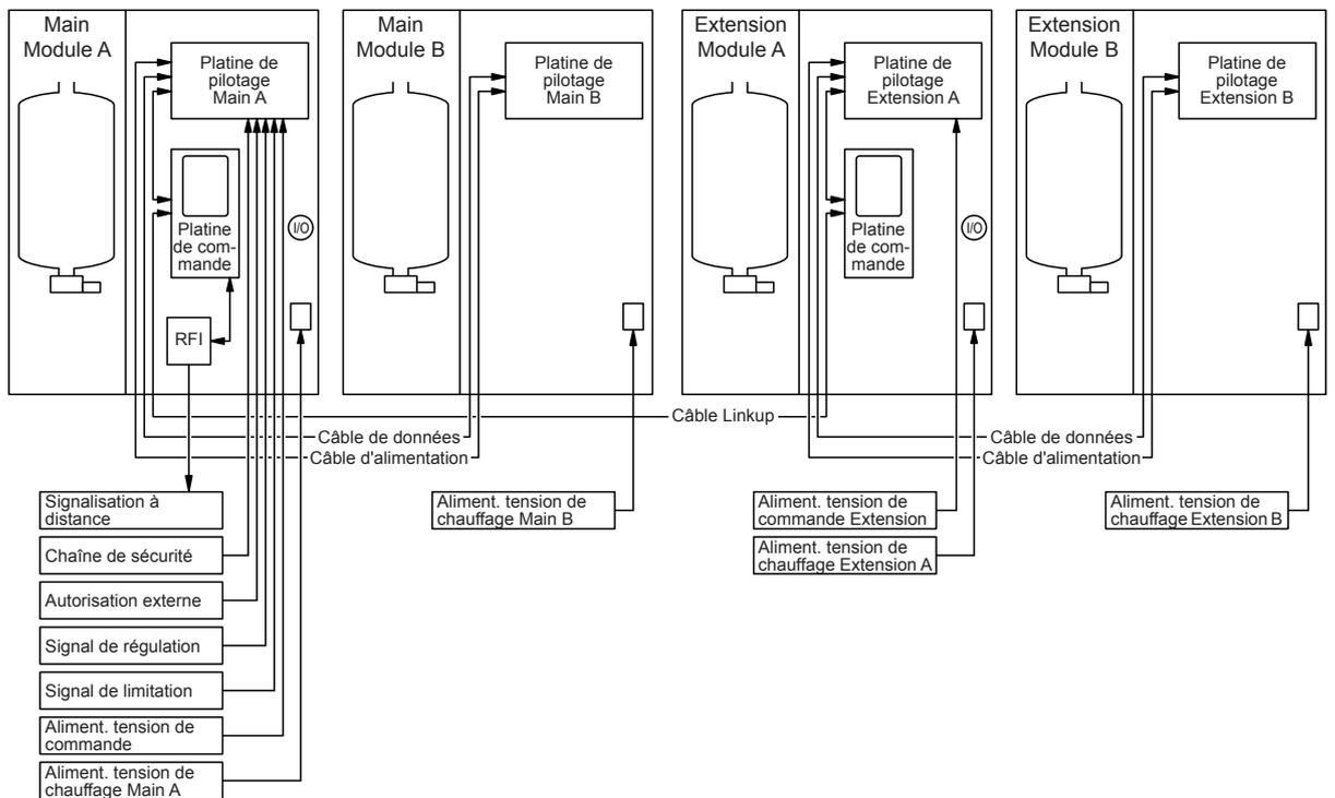
Fig. 5: Aperçu systèmes Linkup (4 x "M")
