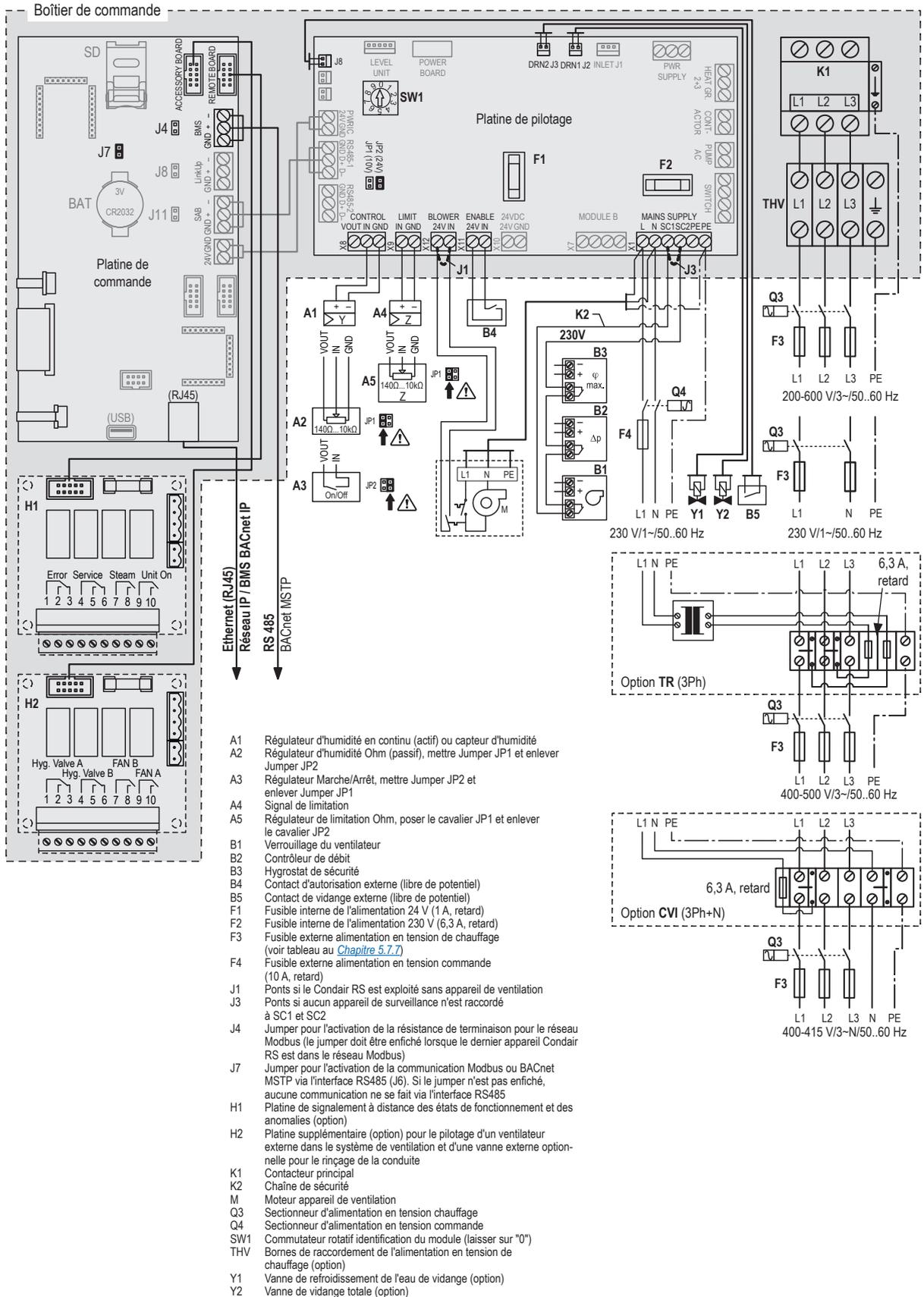
Fig. 27: Schéma électrique Condair RS - Appareils individuels "S" et "M" (5...40 kg/h)
