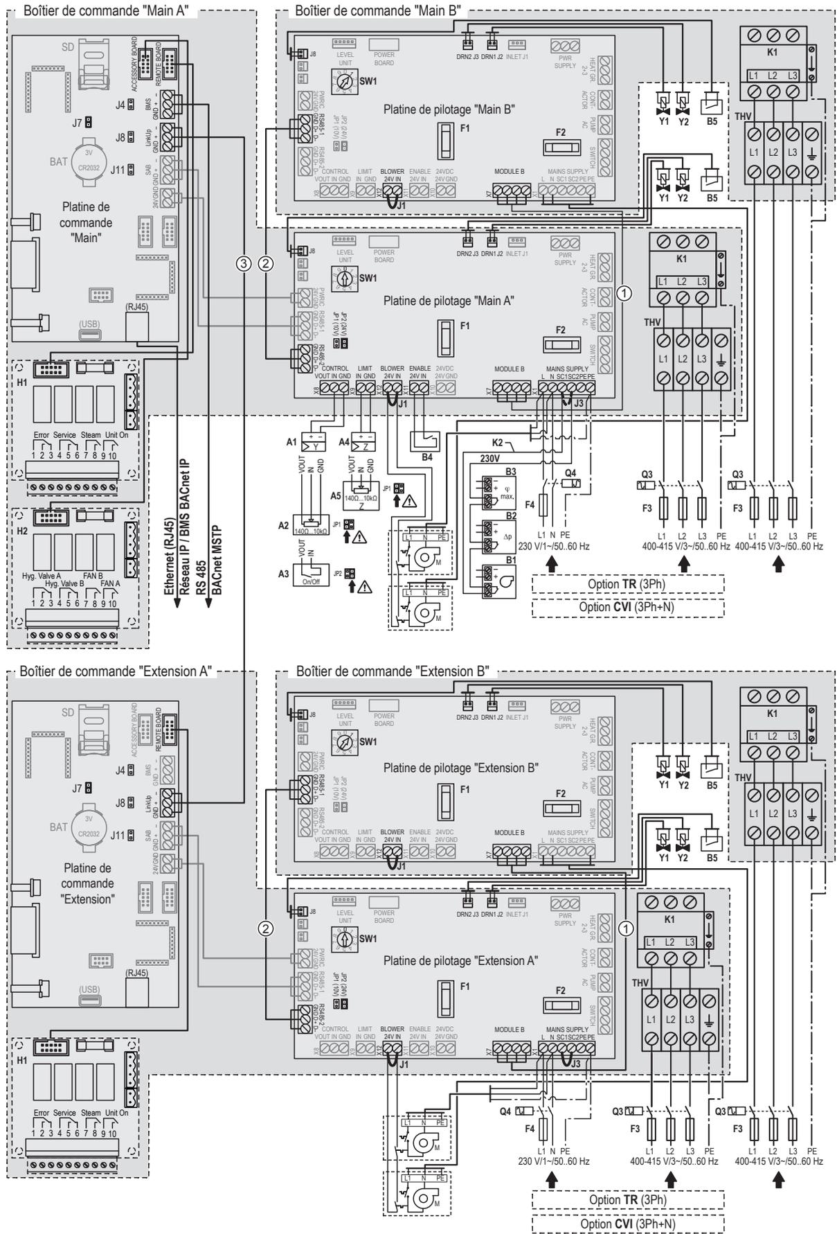
Fig. 30: Schéma électrique Condair RS - Systèmes Linkup 100...160 kg/h
