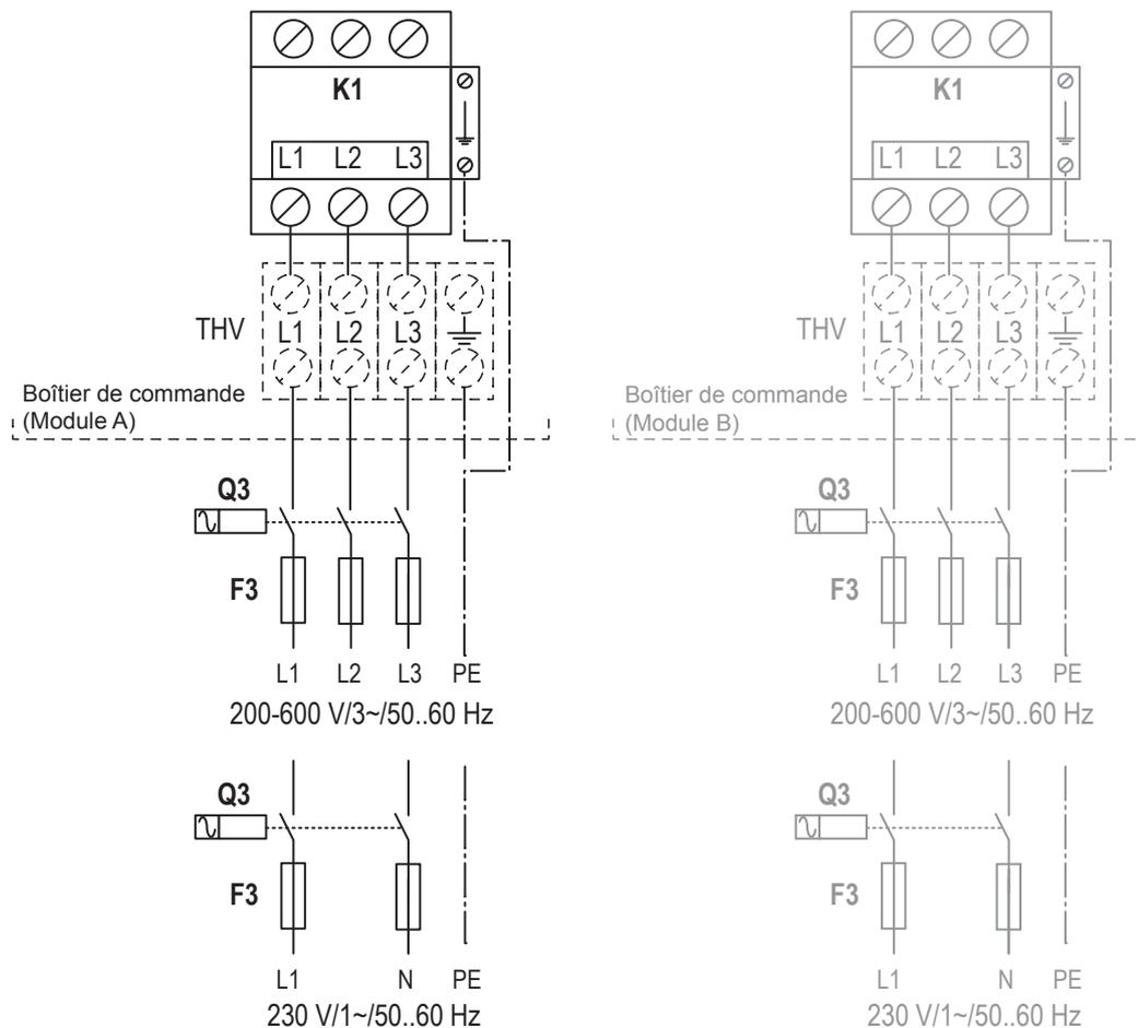
Le raccordement de l'alimentation en tension chauffage (L1, L2, L3 et PE ou L1, N et PE) se fait sur les bornes correspondantes du contacteur principal "K1" (ou sur les bornes correspondantes de la barre à bornes "THV") conformément au schéma. Le câble de raccordement doit absolument être amené dans le boîtier de commande via la fixation de serrage.
