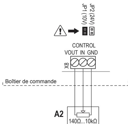
Le câble de signal d'un régulateur d'humidité Ohm ( $140 \Omega \dots 10 \text{ k}\Omega$ ) est connecté aux contacts "VOUT", "IN" et "GND" sur la platine de pilotage du boîtier de commande conformément au schéma.
