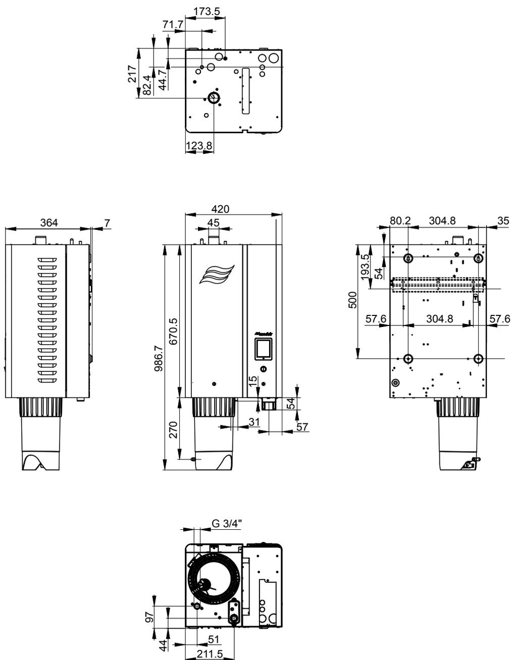
Fig. 31: Dimensions appareil "Small" (mesures en mm)
