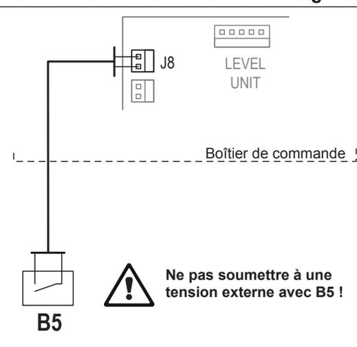
Le contact sans potentiel d'un contact de vidange externe est connecté aux bornes du bornier "J8" de la platine de pilotage correspondante conformément au schéma. Le câble de raccordement doit être conduit dans l'unité de commande par un raccord de câble à vis.
