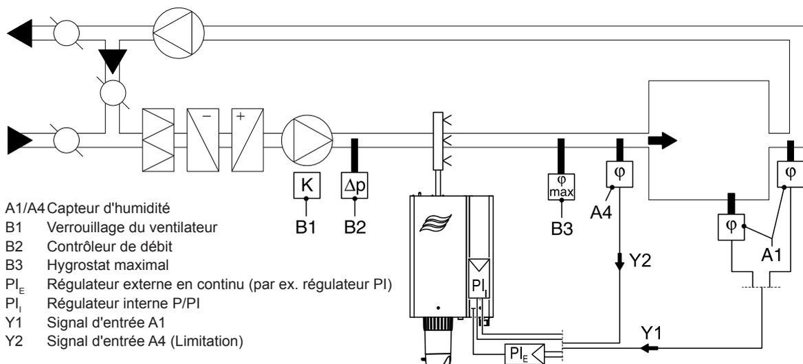
Fig. 25: Système 2 – Régulation de l'humidité ambiante avec limitation constante de l'humidité de l'air
