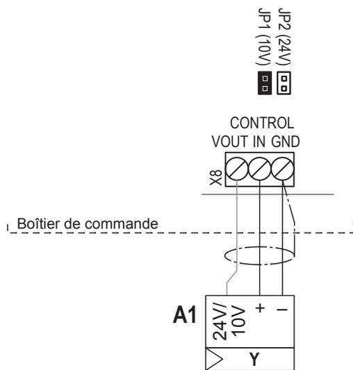
Le câble de signal d'un régulateur externe ou d'un capteur d'humidité (en cas d'utilisation du régulateur interne P/PI) est connecté aux bornes "IN" et "GND" de la platine de pilotage. Le câble de raccordement doit être conduit dans le boîtier de commande par un raccord de câble à vis.
