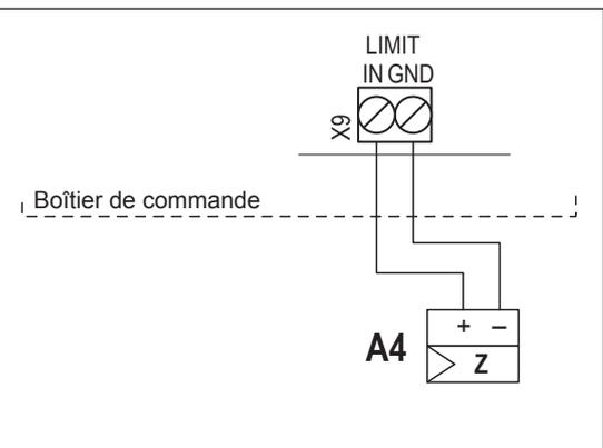
Le câble de signal d'un limiteur externe (régulateur en continu P/PI) ou d'un capteur d'humidité (en cas d'utilisation du régulateur P/PI interne) est connecté aux bornes "IN" (+) et "GND" (-) sur la platine de pilotage du boîtier de commande.
