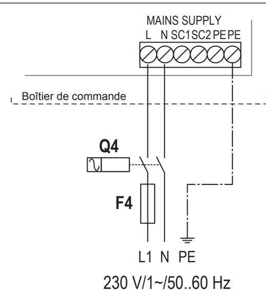
Le raccordement de l'alimentation en tension commande (L1, N, PE) se fait sur les bornes correspondantes de la platine de pilotage conformément au schéma.
