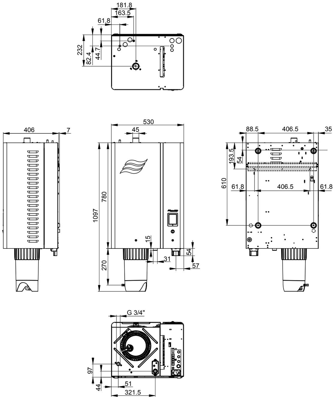
Fig. 32: Dimensions appareil "M" (mesures en mm)
