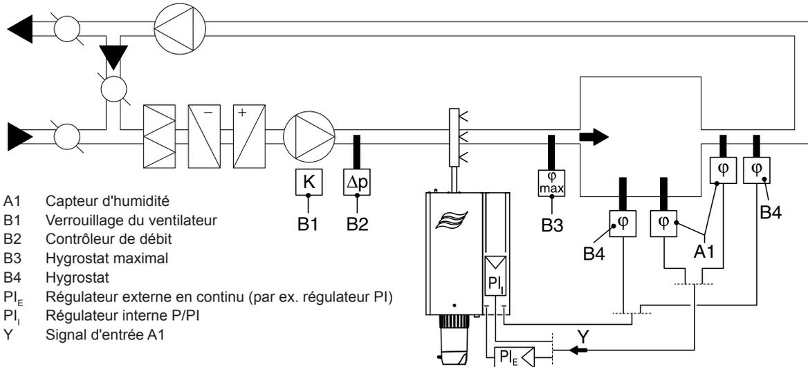
Fig. 24: Système 1 – Régulation de l'humidité ambiante
