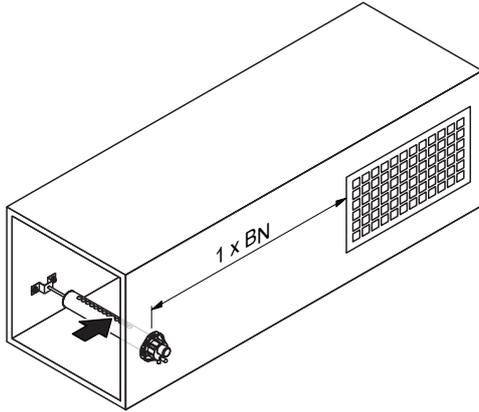
**avant régulateur d'humidité/capteur d'humidité**
