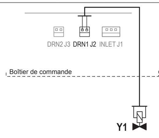
Le câble de raccordement de la vanne de refroidissement de l'eau de vidange "Y1" disponible en option est raccordé à la barrette à bornes "DRN1 J2" de la platine de pilotage correspondante dans l'unité de commande conformément au schéma.
