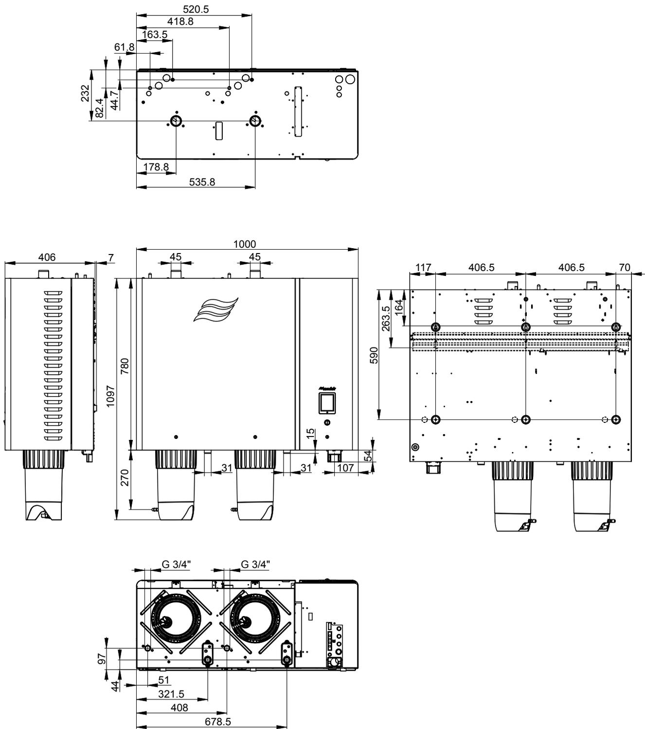
Fig. 33: Dimensions appareil "L" (mesures en mm)
