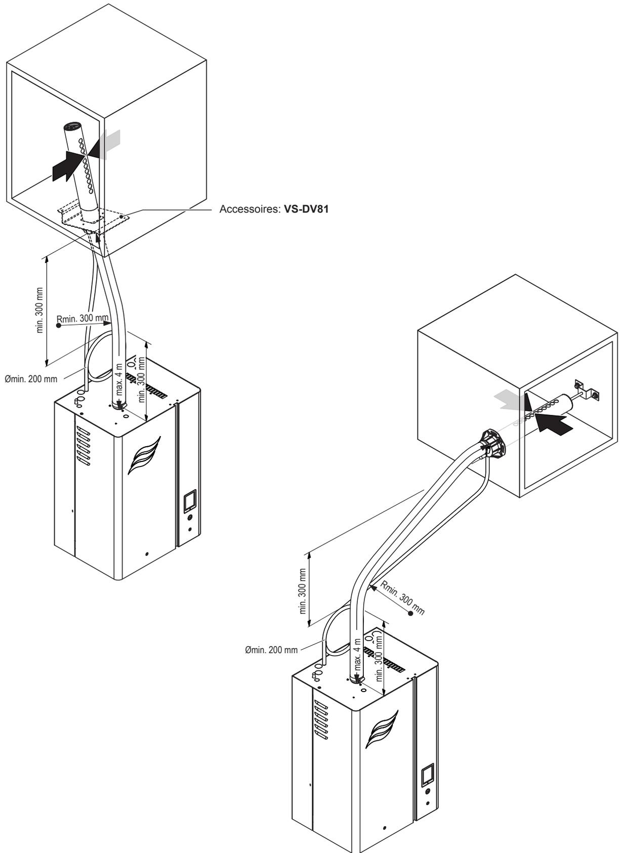
Fig. 17: Tuyau de distribution de vapeur monté à plus de 500 mm au-dessus du bord supérieur de l'appareil
