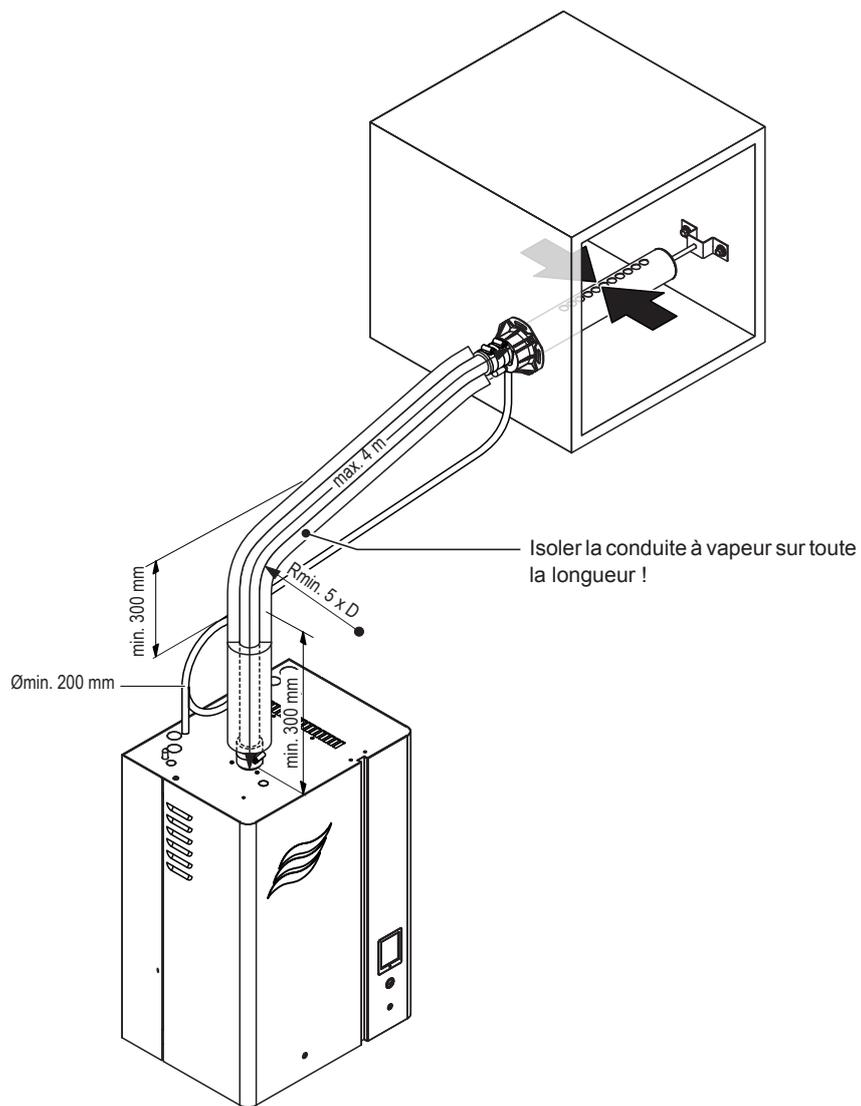
Fig. 19: Conduite à vapeur avec tuyauterie et isolation
