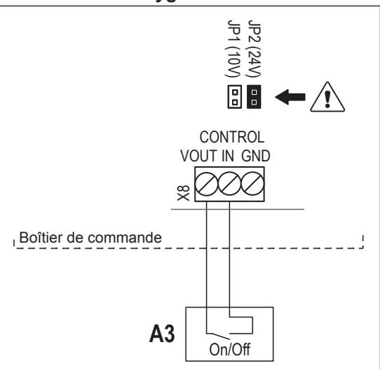
Le câble de signal d'un hygrostat Marche/Arrêt 24 V est connecté aux contacts "VOUT" et "IN" sur la platine de pilotage du boîtier de commande conformément au schéma.
