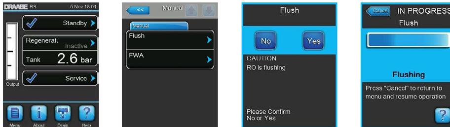
1. Appuyez sur le bouton **<Drain>** dans l'affichage de fonctionnement standard. Le sous-menu « Manual » s'affiche.
