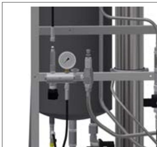
Placez le S1 (interrupteur marche/arrêt) en position arrêt et raccordez la conduite d'évacuation haute pression au collecteur haute pression.
