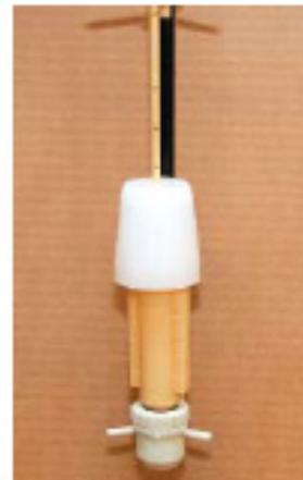
4. Lors de l'installation de la vanne de sel, veillez à ne pas la laisser tomber dans le cylindre. Si elle tombe, le flotteur peut couler et donner un réglage incorrect. Placez la vanne de sorte que la conduite coudée 3/8" se trouve le long de l'arrière du puits de sel, à bonne distance de la paroi du cylindre. À présent, appuyez la conduite coudée de 3/8" sur l'entaille, afin qu'elle dépasse de 25 mm du cylindre d'eau salée (voir photo à droite).
