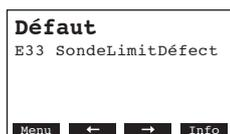
Généralement, l'exploitation n'est plus possible, l'appareil est bloqué. Le dépannage des dérangements est décrit aux chapitres 6.2. et 6.3.
