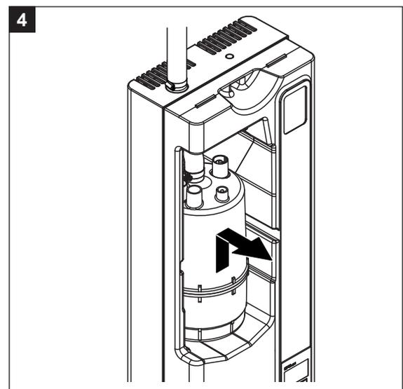
3. Déconnecter les connecteurs d'avec les électrodes et d'avec la sonde de niveau.
