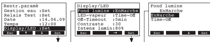
Dans le dialogue modifications, déterminez si l’arrière-plan doit être éclairé en permanence (On) ou si l’éclairage doit s’éteindre après un temps déterminé (Time-Off).
