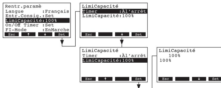
Laissez le timer désactivé (Off) ou désactivez-le au besoin. Sélectionnez "**LimiCapacité**" et pressez la touche **<Set>**. Dans le dialogue modifications, déterminez la limitation de débit fixe en % (réglage d'usine: 100 %, plage de réglage: appareil 4kg/h: 30-100 %, appareil 2kg/h: 50-100 %).
