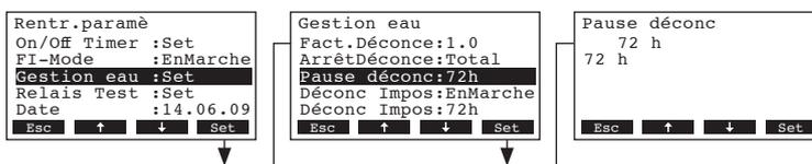
Dans le dialogue modifications, déterminez la durée, en exploitation standby, au terme de laquelle une vidange automatique de cylindre doit être effectuée.
