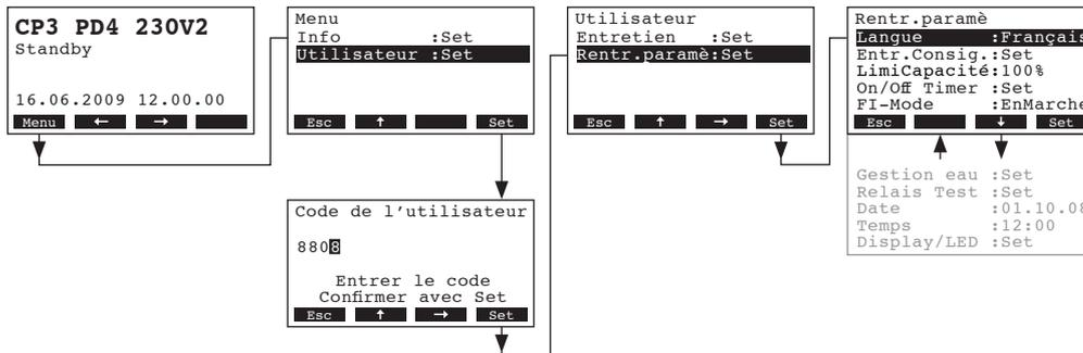
Sélectionnez les divers réglages resp. les sous-menus de réglage avec les touches <↔> et <↑>. Dans les chapitres suivants figurent d'autres informations concernant les divers réglages.
