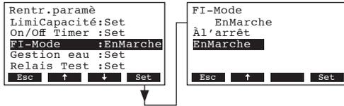
Dans le dialogue modification, déterminez si le Condair CP3mini est raccordé à un réseau électrique équipé d'un coupe-circuit instantané ou non.
