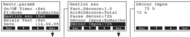
Dans le dialogue modifications, déterminez la durée d'exploitation au terme de laquelle un rinçage forcé automatique doit être effectué.
