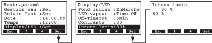
Dans le dialogue modifications, déterminez la valeur désirée de l'intensité de l'éclairage en arrière-plan en % de la valeur maximale.
