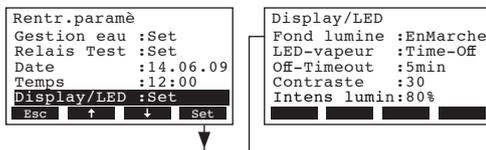
Le sous-menu pour la configuration de l’affichage apparaît. Sélectionnez les divers réglages avec les touches <↔> et <↑>. Les chapitres suivants donnent de plus amples informations au sujet des divers réglages.
