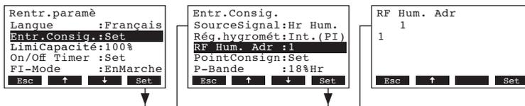
Dans le dialogue modifications, déterminez l'adresse radio pour la sonde hygrométrique à radio-commande.
