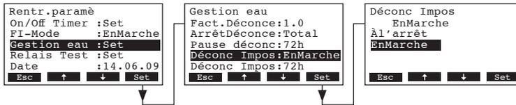
Dans le dialogue modifications, activez/désactivez le rinçage forcé après un temps d'exploitation déterminé (voir réglage suivant).
