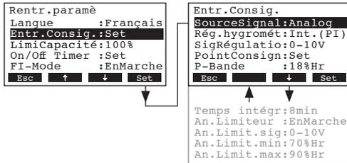
Les paramètres de réglages d'asservissement apparaissent. Les réglages possibles dépendent de la source de signal et du mode de régulation sélectionnés. Dans l'illustration ci-dessus figure le nombre maximal de réglages à disposition. Vous trouverez de plus amples informations concernant les divers réglages aux chapitres suivants.
