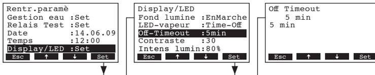
Dans le dialogue modifications, déterminez le temps imparti au terme duquel l'éclairage en arrière-plan et/ou la LED vapeur doivent s'éteindre.
