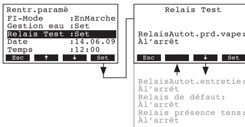
La liste des tests relais apparaît, le premier test de relais est visualisé (relais vapeur).
