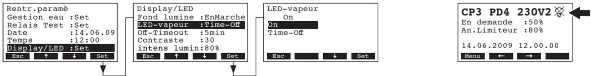
Dans le dialogue modifications, déterminez si la LED vapeur doit être allumée en permanence (On) au cours de la production de vapeur ou si elle doit s'éteindre après une durée déterminée (Time-Off).
