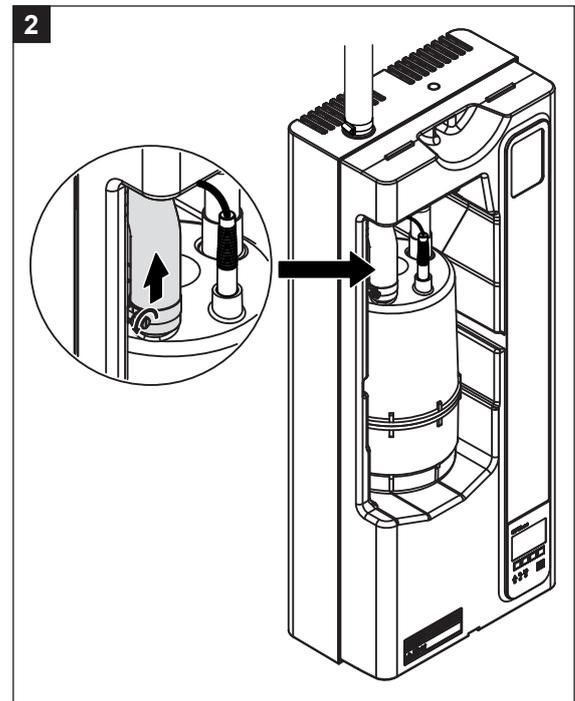
1. Au bas de la paroi intermédiaire, desserrer de quelques tours la vis fixant la protection frontale. Retirer le bas de la protection frontale vers l'avant, puis la pousser vers le haut et l'enlever.
