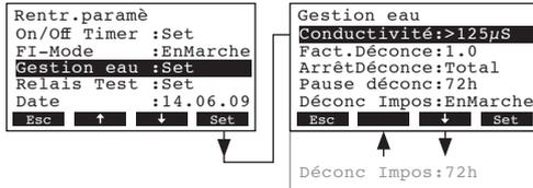
Les paramètres de réglages pour la gestion d'eau apparaissent. Sélectionnez le réglage désiré avec les touches <↓> et <↑>. Les chapitres suivants donnent de plus amples informations concernant les divers réglages.
